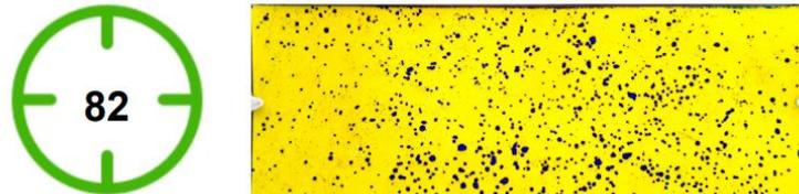
Para este tipo de tratamientos se recomienda configurar la pulverizadora con boquillas de cono hueco, con el objetivo de generar un espectro de gotas homogéneas tal que nos permita obtener buenas coberturas de impactos y penetrar mejor en canopeos densos.
